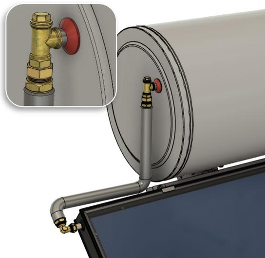
**Avvitare il tappo in bronzo con l'anello in rame sul punto di riempimento per sigillare il sistema a circuito chiuso. Il circuito chiuso è permanentemente sigillato.**
